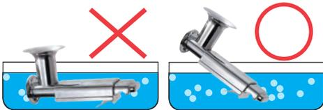
Pour éviter la corrosion et les dommages sur le capteur magnétique assurez-vous que le boîtier n'est pas complètement immergé.
